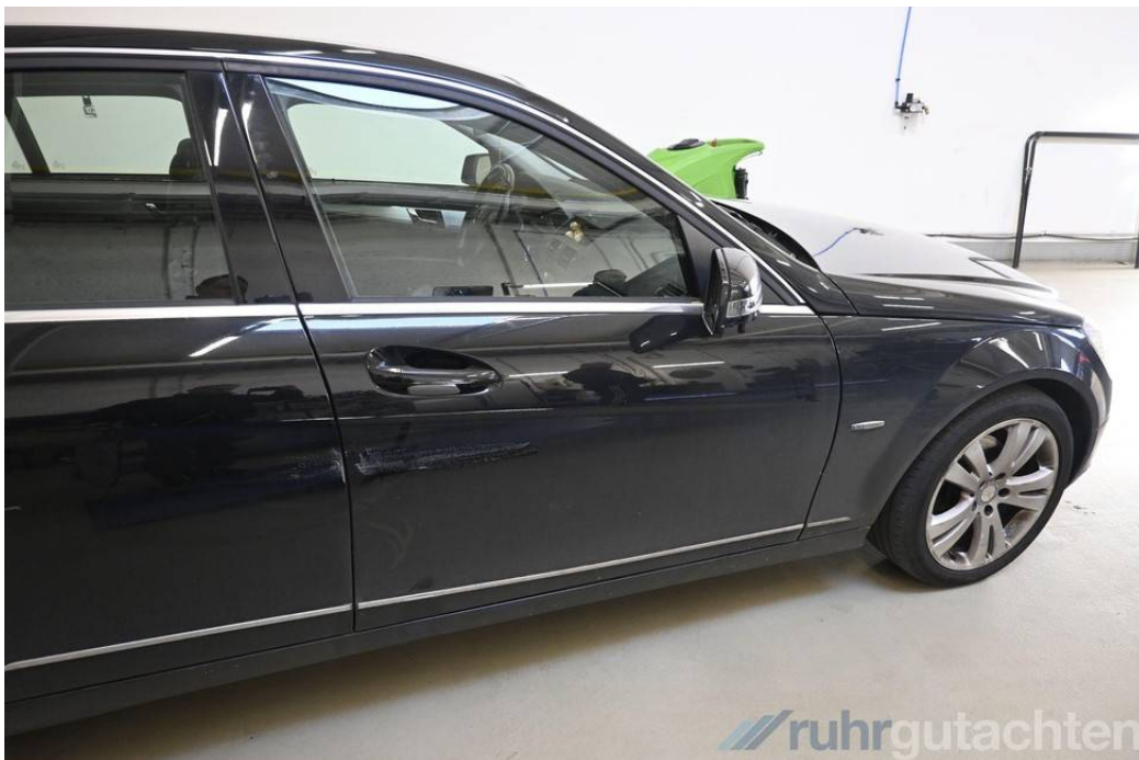
Tür vorne rechts kratzbeschädigt
